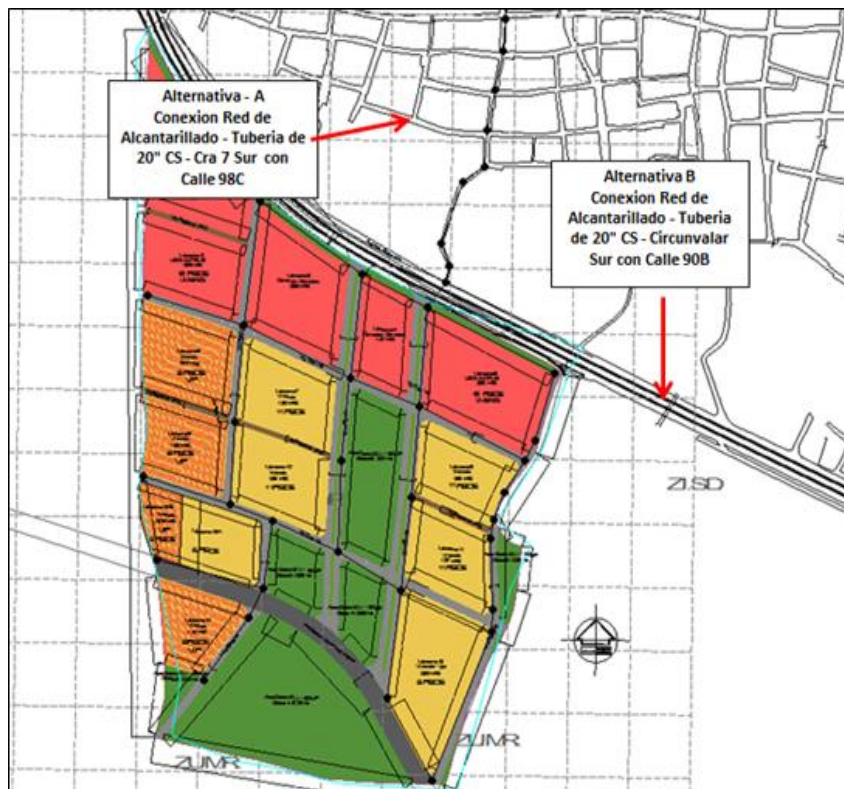
Imagen 46. Conexión al Sistema de Alcantarillado.
